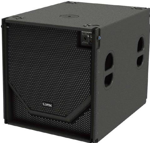
CLS-118SP 是一款大功率输出，功能强大的超低音音箱，旨在与 CLS-28P 同轴线阵列音箱一起使用。它使用了一个低失真的 18" (4.5" 分体绕组铜音圈) 定制单元。前后电源及音频接口，三只以上的低音，可以按照常规方式，做全向使用，如果用于心形指向使用是，也能安装简易，在音箱的前端看不到任何电缆。通过以太网端口，整个系统可以通过 OCS 平台进行控制，完成对整个阵列的调试及监测，并与新的 Rainbow 3D 设计软件一起提供了一个完整的系统方案。箱体由高档桦木胶合板制成，表面涂有一层聚脲涂层，具有更长的耐久性，适合多种复杂的天气。应用场地：流动演出、固定安装、体育馆，音乐厅，礼堂，教堂，俱乐部、CLS-28P 的低频补充。
