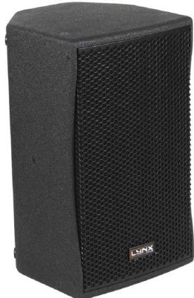
BS-10 是一个紧凑型二分频无源扬声器。由单 10"(2" 音圈) 低频驱动器以及 1" 高频驱动器组成，具有 90°×60° 可旋转号筒并有很广泛的适用范围从固定安装，前置补声以及作为舞台监听被使用。
