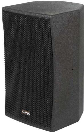
BS-12 是一个紧凑型二分频无源扬声器。由单 12"(3" 音圈) 低频驱动器以及 1 英寸高频单元组成，具有 90°x60° 可旋转号筒并有很广泛的适用范围从固定安装，前置补声以及作为舞台监听被使用。
